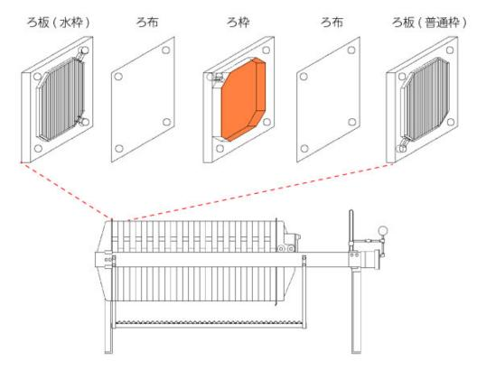
フィルタープレスは、ろ板(水枠)→ろ布→ろ枠→ろ布→ろ板(普通枠)と重ね、その次は ろ布→ろ板(普通枠)→ろ布→ろ枠→ろ布→ろ板(普通枠)を繰り返し重ね、ろ枠やろ板、 ろ布にある四隅の穴が重なることでスラリーや洗浄水の通り道を構成します。スラリーは、 ろ布とろ板に挟まれたろ枠の空間に流し込まれます。このろ枠の空間に固形分が充填され脱水 ケーキとなり、ろ布を通り抜けたろ液はろ板を伝い、設備外へ排出されます。
