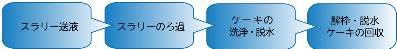
攪拌した原料スラリーをポンプでフィルタープレスに送り、加圧・ろ過・分離します。ほとんどの場合、分離された固形分（＝脱水ケーキ）は製品へ、分離された水分（＝ろ液）は廃液として排出するか、コンテナで回収します。当社で一般的な設備フローは下図の通りです。
