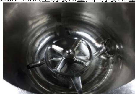
SMG-200(上羽根:S型/下羽根:BL型)
