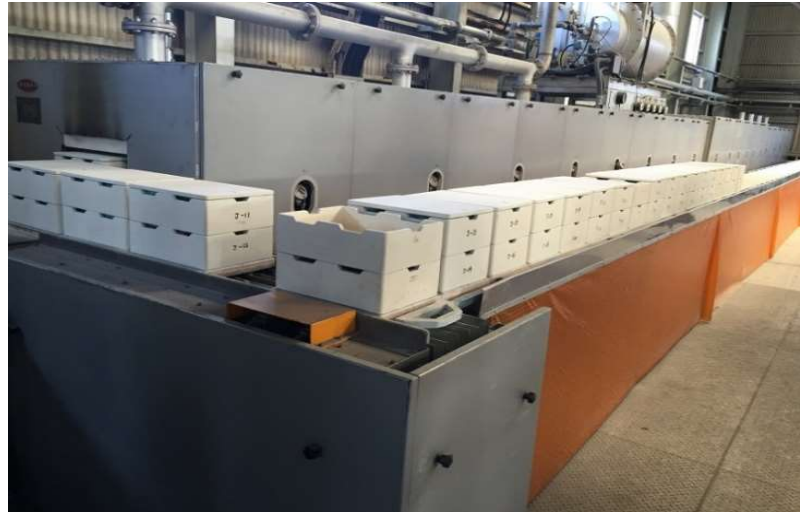
外観写真：匣鉢を2段積焼成している様子
