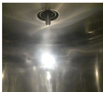
Fig.2 二流体ノズル噴霧時
